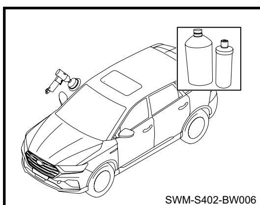
2. 取适量抛光膏涂于待抛光漆面上，调整抛光机转速
