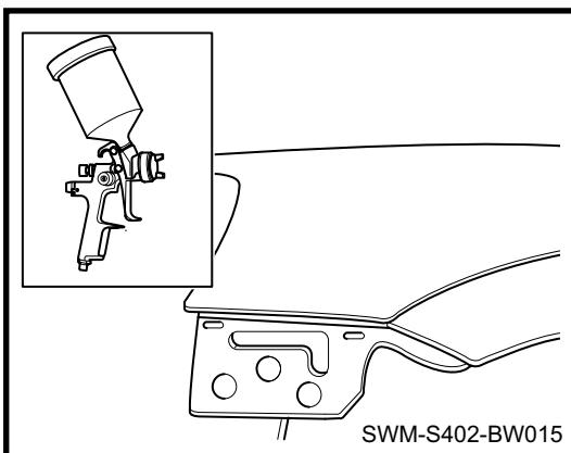
4. 喷涂中涂底漆，尽量控制喷涂底漆的范围，边缘位置涂层要渐进，不要呈阶梯状
