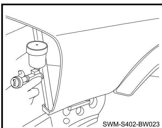
14. 闪干 2~3min，喷涂第二道透明漆，喷涂范围完全覆盖第一层清漆的范围
