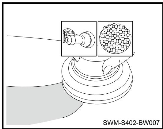
5. 先将海绵充分湿润，挤去多余水分；取少量上光蜡涂抹在待抛漆面上，将海绵贴上漆面后再开机，转速2500~3000r/min。再轻压3~5s进行上光处理
