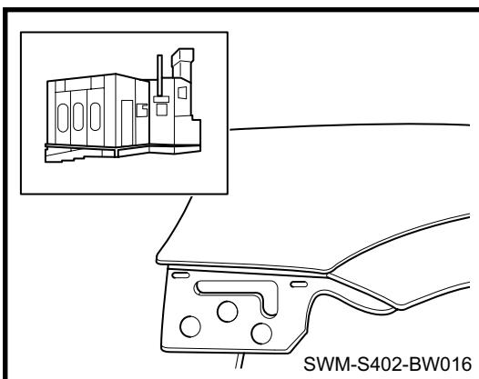
5. 闪干 4~5min，之后进行干燥，烘干 20~30min 烤漆房温度 70~80°C
