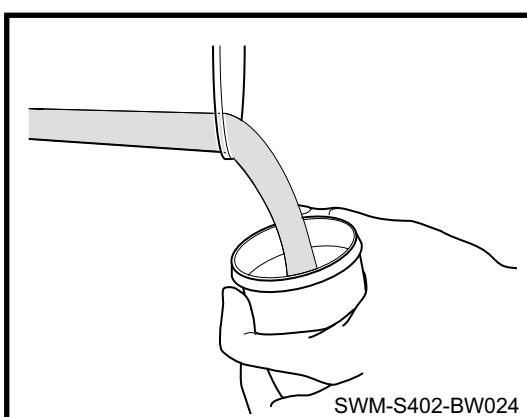
15. 完成透明漆喷涂后，立刻换上驳口水或在原有透明漆中加入接口添加剂或稀释剂
