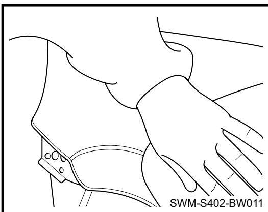
**8. 打磨完成后用粘性纱布进行喷漆前的除尘工作**
