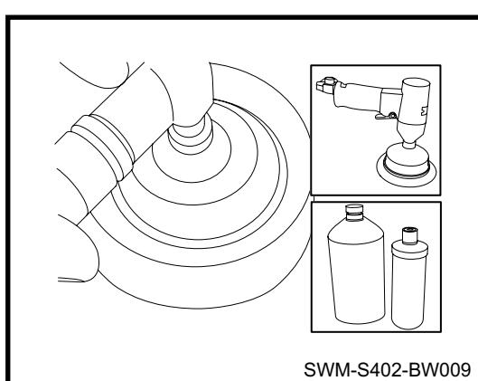
3. 将羊毛球贴上漆面后再开机，转速2500~3000r/min
