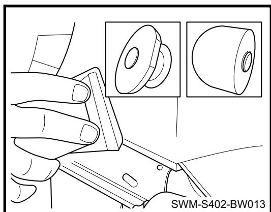
2. 用 P500 # 湿(水)砂纸在受损漆面上进行打磨处理(圆打磨)
