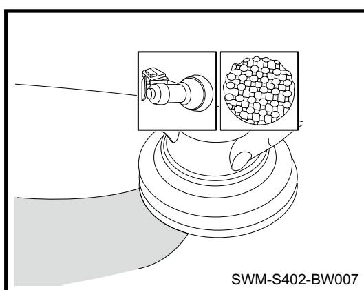
4. 先将海绵充分湿润，挤去多余水分；取少量上光蜡涂抹在待抛漆面上，将海绵贴上漆面后再开机，转速2500~3000r/min。再轻压3~5s进行上光处理
