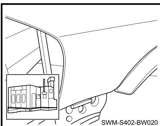
**11. 闪干 4~5min，之后进行干燥 20~30min 烤漆房温度 70~80°C**
